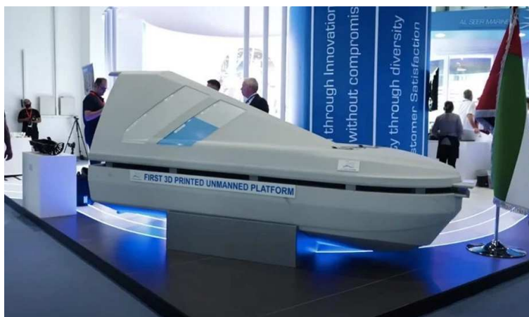
Рис. 5. Hydra — беспилотное надводное судно (БНС), напечатанное на 3D-принтере (Al Seer Marine, ОАЭ)
