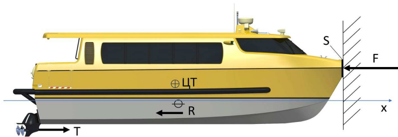
Рис. 3. Система координат и схема сил, действующих на судно при столкновении
