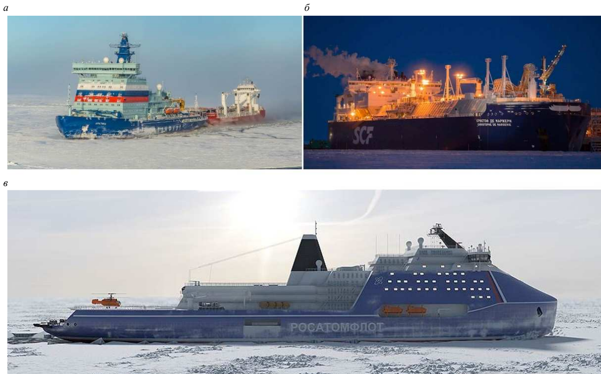
Рис. 6. Атомный ледокол проекта 22220 «Арктика» [14] (а); СПГ-газовоз «Кристоф де Маржери» класса Arc7 [15] (б); ледокол «Лидер» проекта 10510 [16, источник: ЦКБ «Айсберг»] (в)
