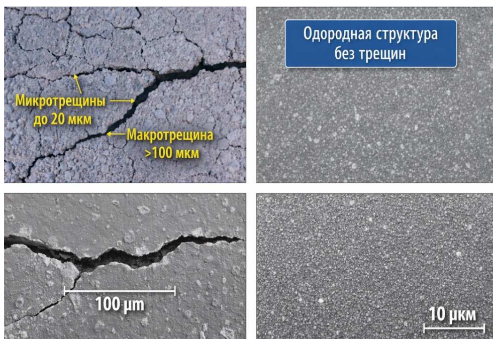
Рис. 2. Сравнение микроструктуры стандартного и модифицированного покрытий после климатических циклов
