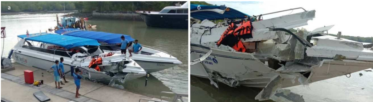
Рис. 1. Последствия аварии «спидботов» на о. Пхукет в феврале 2020 г.: а — общий вид судна; б — носовая зона повреждения, показано разрушение конструкции 1
