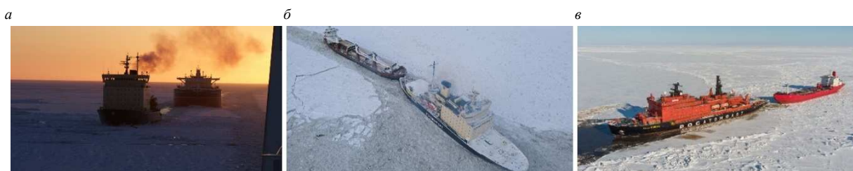
Рис. 13. Основные способы осуществления ледовой проводки в Арктике: а — метод лидирования; б — метод буксировки вплотную («на усах»); в — метод буксировки на коротком буксире в канале в припайных льдах
