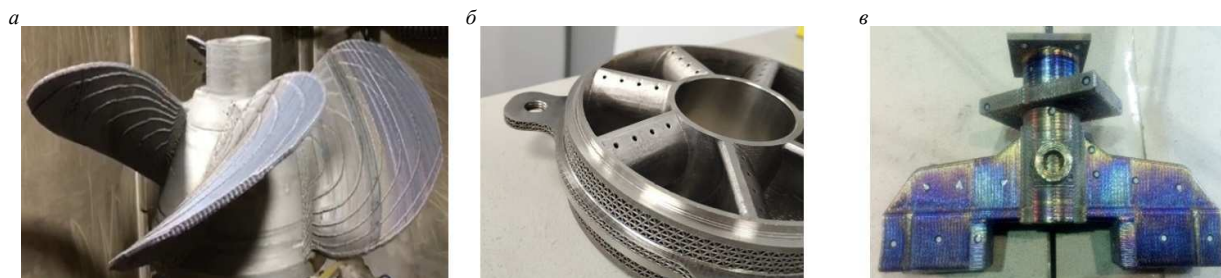
Рис. 6. Примеры изделий для судостроения, полученные аддитивными методами в результате НИР: а — гребной винт (ТЛВ, ИЛИСТ); б — колесо для гидравлического привода (СЛС, АО «ОСК»); в — деталь «корпус» (ТЛВ, ИЛИСТ)
