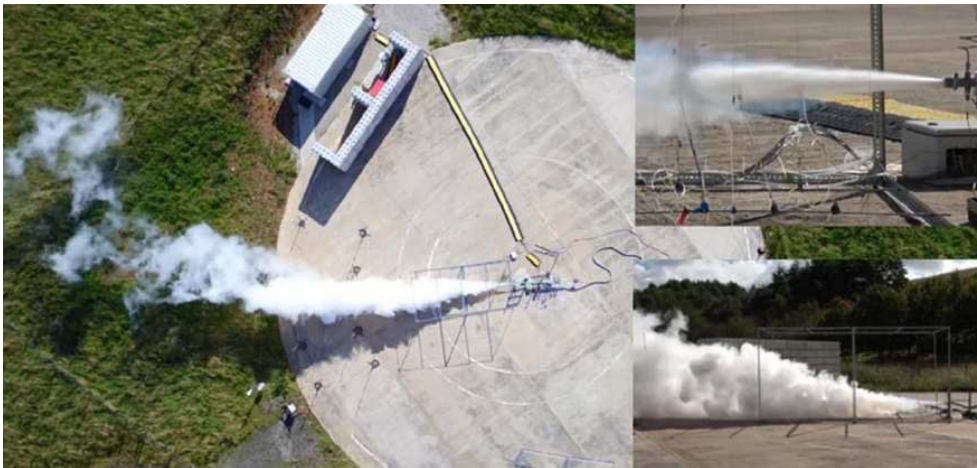
Рис. 5. Видимый водяной туман в воздухе при утечке \text{LH}_2 [9]
