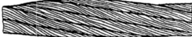
Рис. 3.7.7.1.15 Местное увеличение/уменьшение диаметра троса
