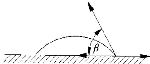
Рис. 2.5.7.1 Смачиваемость твердого тела жидкостью:
