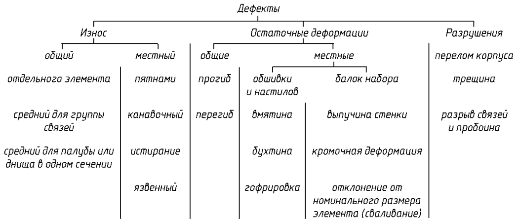
Рис. П2.2.2. Классификация дефектов корпуса судна
