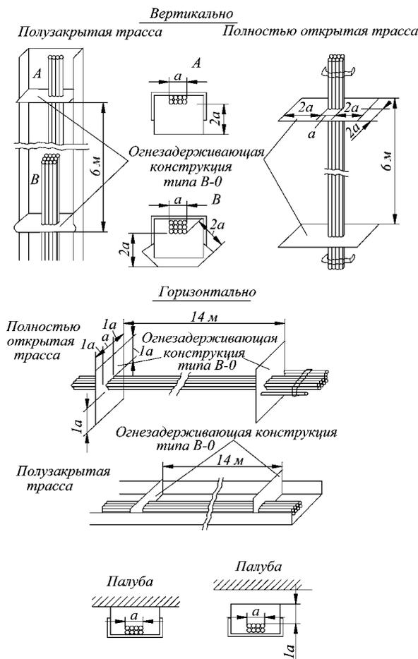
Рис. 16.8.4.3.2-2 Защита кабельных трасс огнезадерживающими конструкциями типа В-О
