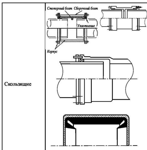
**2.4.5.7** Механические соединения не должны применяться на участках трубопроводов, где их повреждение может привести к затоплению или возникновению пожара, в частности для подключения к бортовым отверстиям ниже палубы переборок на пассажирских судах и палубы надводного борта на грузовых судах или к цистернам, содержащим воспламеняющиеся среды.
