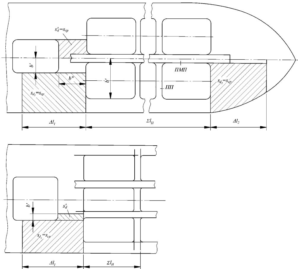
Рис. 1.4.8.2 Учет продольных межблоковых перемычек при определении момента сопротивления поперечного сечения корпуса
