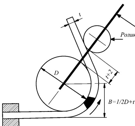
Рис. 4.9.3.6 Схема проведения испытаний на статический изгиб по методике, предусматривающей оборачивание образца вокруг оправки
