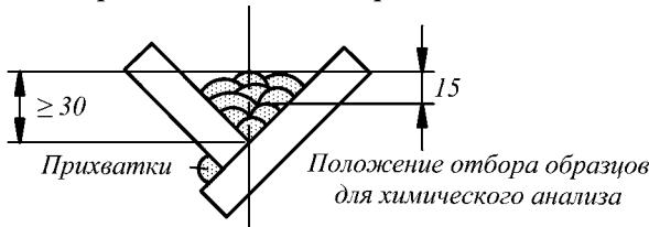
Рис. 4.10.2 Проба для испытаний наплавленного металла
