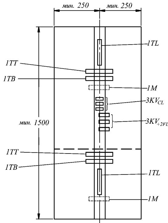
Рис. 4.6.2.3-1 Проба стыкового соединения для испытаний по одобрению электрогазовой и электрошлаковой сварки.
