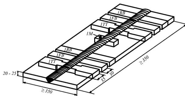
Рис. 4.10.3.1-2 Дополнительная проба стыкового соединения для сварки в нижнем пространственном положении:
