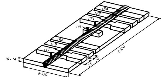
Рис. 4.10.3.1-1 Проба стыкового соединения для сварки в различных пространственных положениях:
