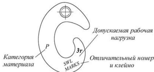
Рис. 11.2.1-1 Маркировка гака
