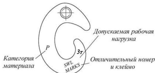
Рис. 11.2.1-1 Маркировка гака
