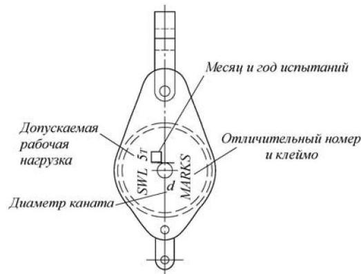
Рис. 11.2.1-5 Маркировка блока
