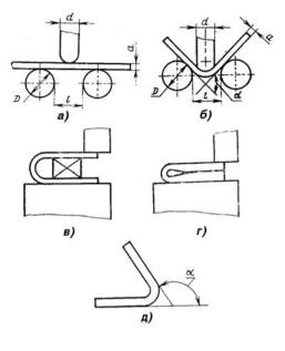
Fig. 3.1 Bend test
