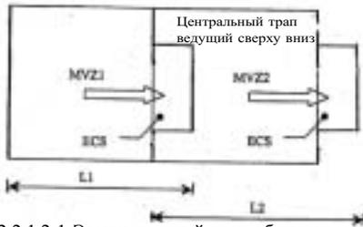
Рис. 2.2.1.2-1 Эвакуационный трап обслуживает одну главную вертикальную зону
