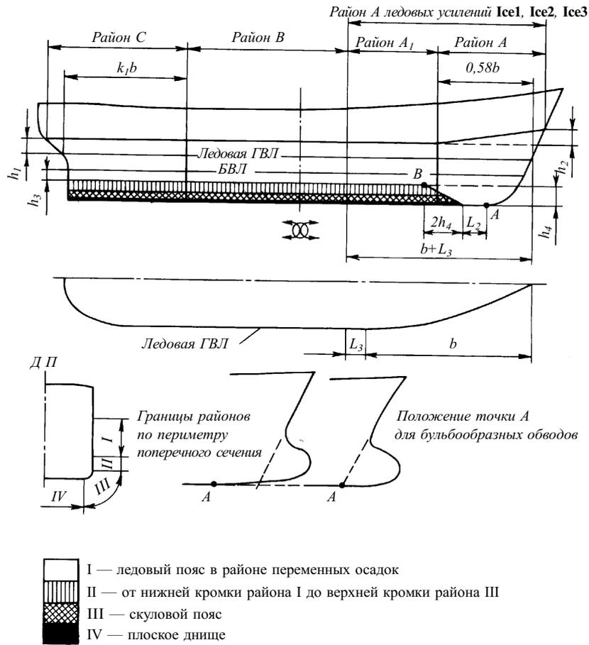
$b$  — расстояние от точки пересечения ледовой ГВЛ с форштевнем до сечения, в котором ледовая ГВЛ имеет наибольшую ширину, но не более  $0,4L$
