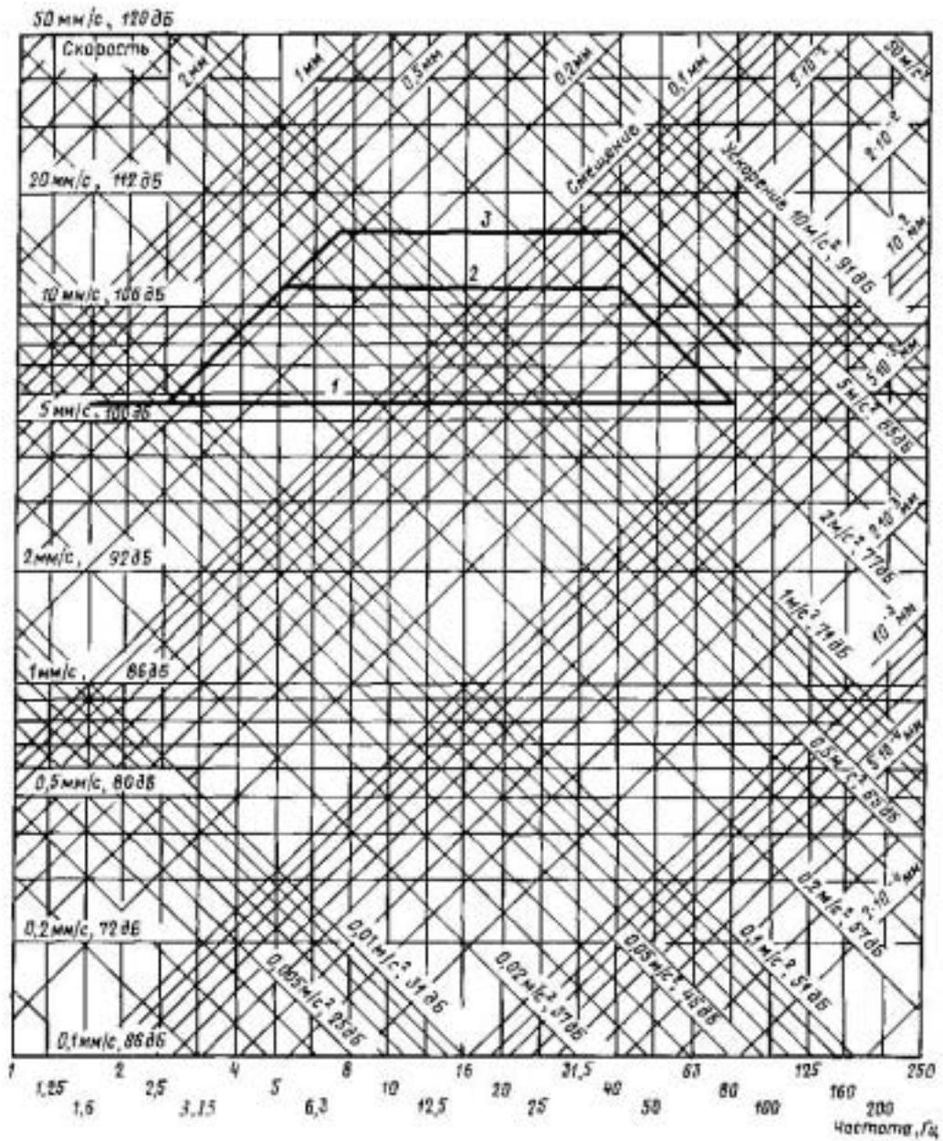
Рис. 1.5.3.4 Допустимые средние квадратические значения виброскорости и виброускорения:
