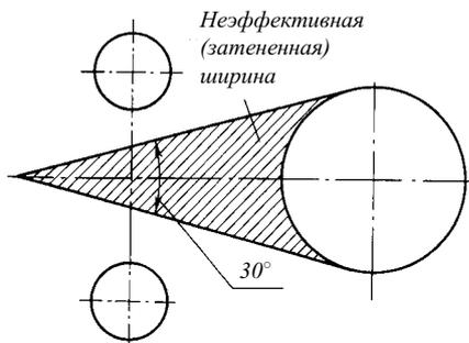
Рис. 1.4.8.3 Расчетное сечение
