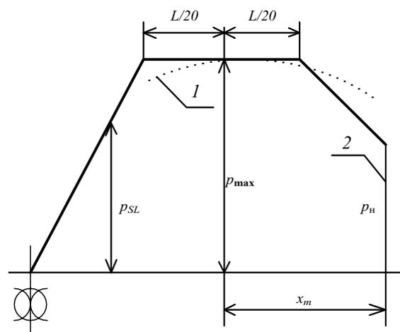
Рис. 2.8.3.2 Схема определения расчетного давления  $p_{SL}$ :
