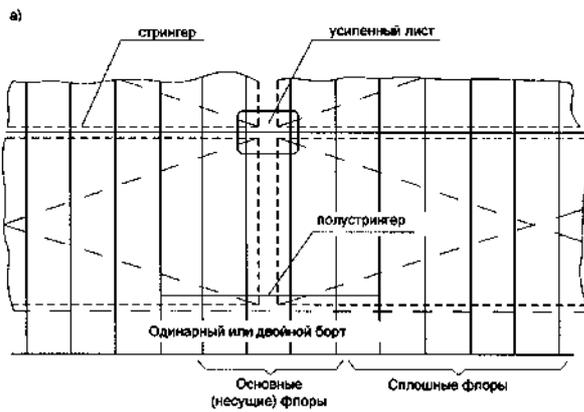
Рис. 3.5.2.2-1 Поперечная система набора
