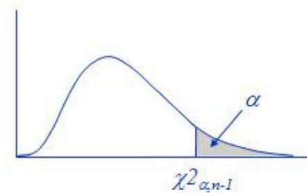
Доверительный уровень стандартного отклонения используется для обеспечения того, чтобы стандартные отклонения при повторных испытаниях находились ниже верхнего предела, получаемого из стандартного отклонения по результатам усталостных испытаний с определенным доверительным уровнем. На рисунке показано распределение хи-квадрат для доверительного диапазона  $(1 - \alpha) \cdot 100$  % для дисперсии.
