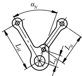
Рис. 2.4.3-2 Прицепной шатун
