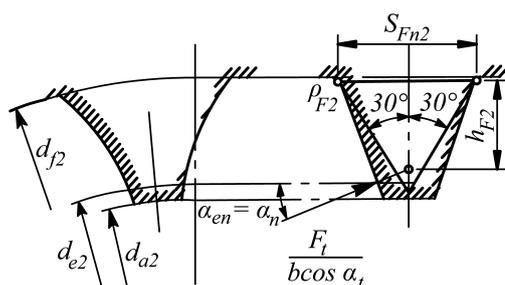
Рис. 4.2.2.7.3.2-4 К определению  $Y_F$  для случая внутреннего зацепления
