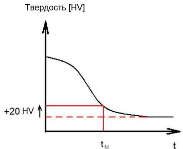
Рис. 5.1. Эскиз условной точки перехода по глубине ( $t$ )
