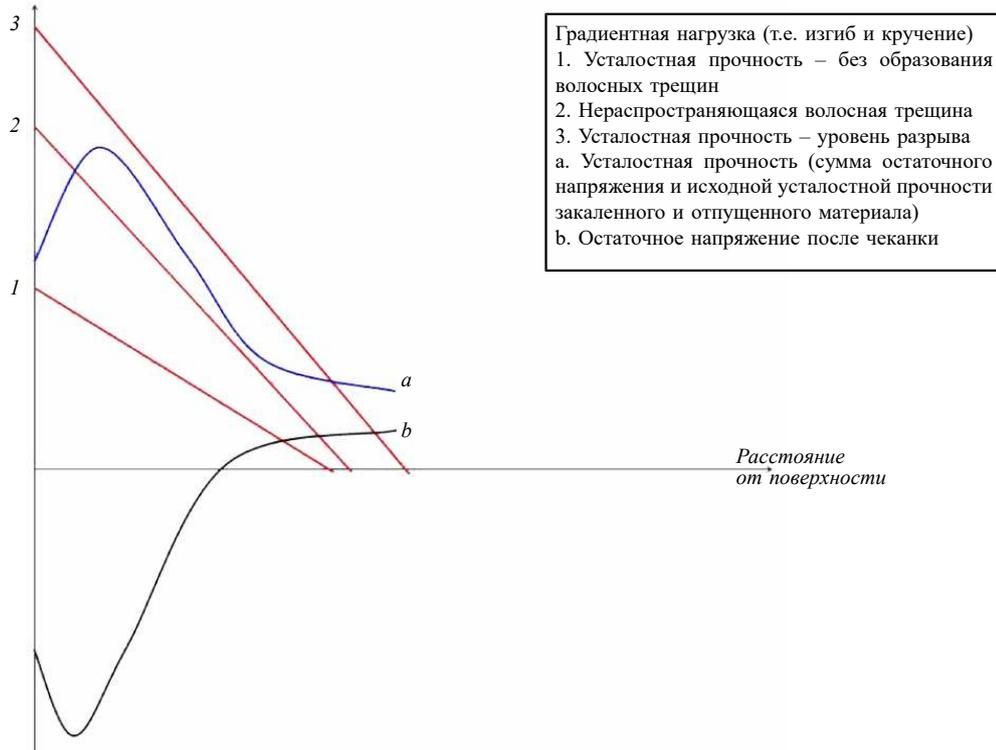
Рис. 6.1. Рабочие и остаточные напряжения под поверхностью после чеканки. Прямые линии 1...3 обозначают возможные градиенты напряжений, вызванных нагрузкой
