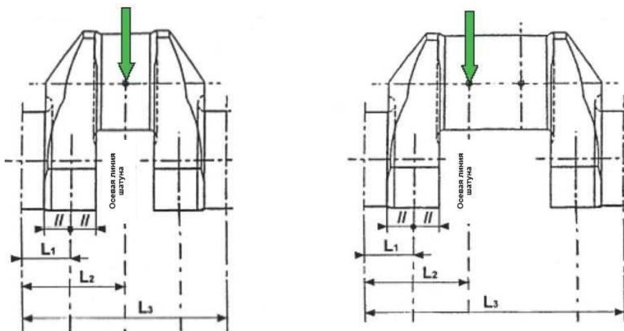
Рис. 3.4. Приложение нагрузки в случае рядного V-образного двигателя
