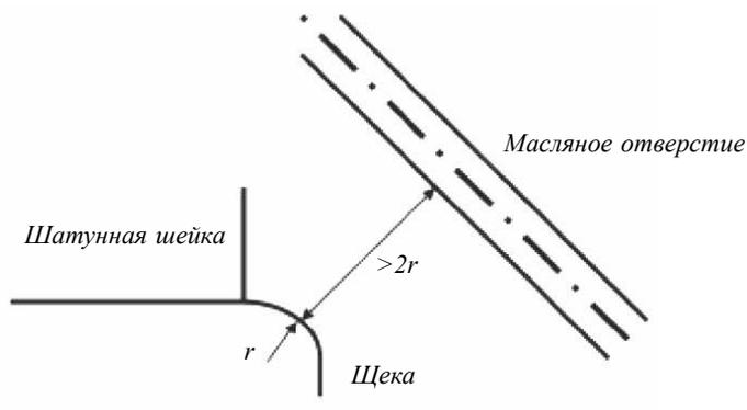
Рис. 2.1. Расстояние между масляным отверстием и галтелью
