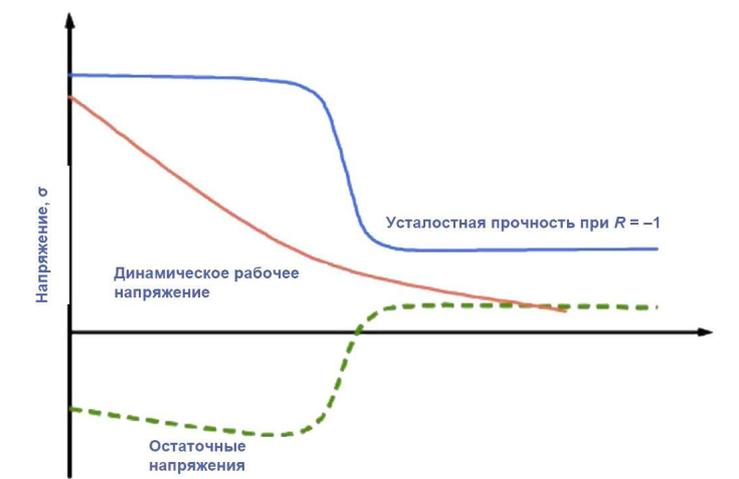
Рис. 3. Общие принципы зависимости напряжений от глубины
