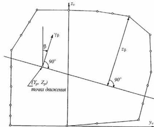
Рис. 3.2-2 Определение внутреннего гидростатического напора
