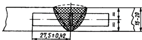
Рис. 4.8.4.1-1 Схема вырезки образцов с V-образным надрезом
